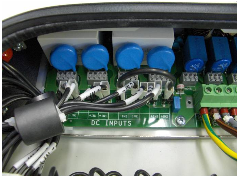
Abb. 13 Für den Kurzschluss des Kanals 2 erforderliche Verbindungen
