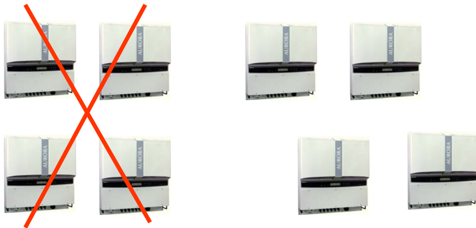
Abb. 7 Empfohlene Einbaulage der Wechselrichter Aurora
